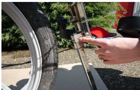
15. Verificare che il piede anteriore sia bloccato
