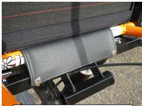
18. Installare il cucino e premere le pressioni
