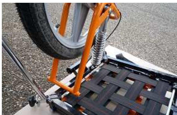
5. Sollevare la ruota e il suo braccio oscillante
